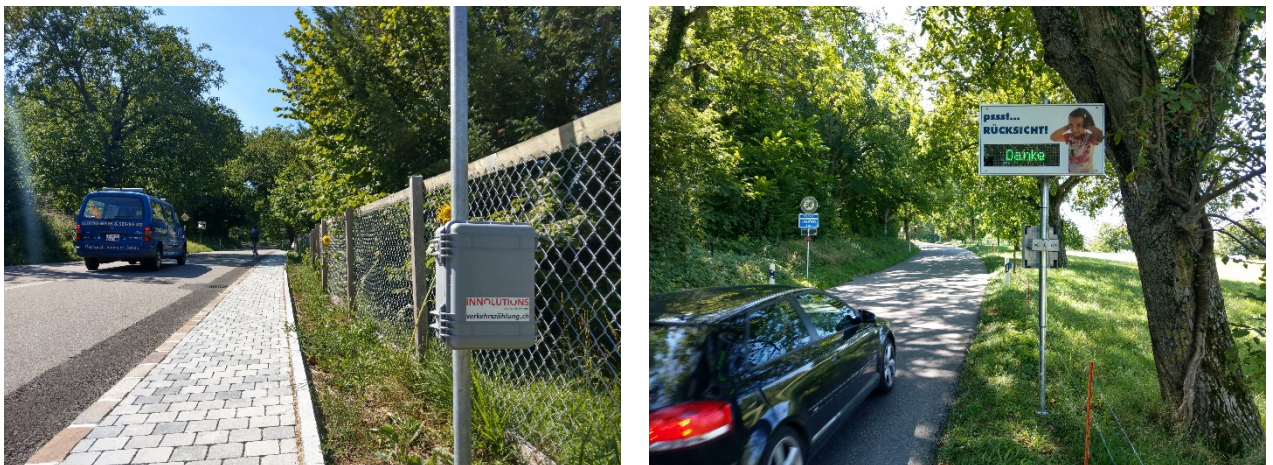
Abbildung 1: Temporär installiertes Messsystem Topo-DD-Lärm von INNOLUTIONS, Messeinheit linkes Bild, Anzeigeeinheit rechtes Bild.
