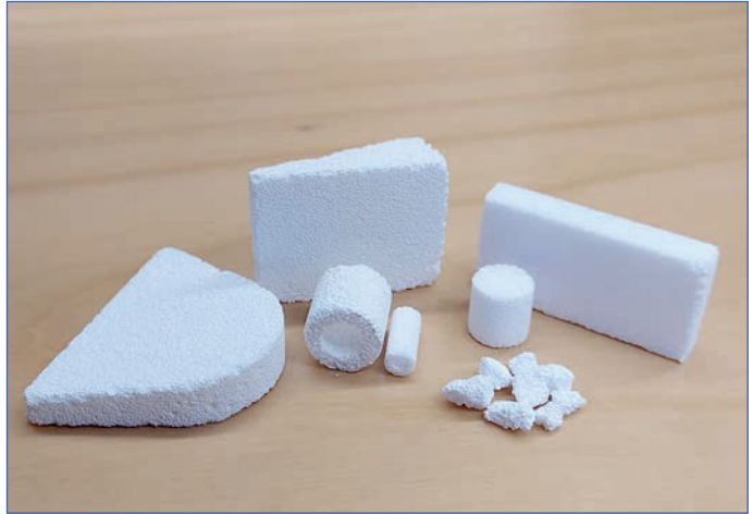
Beispiel für einige Knochenersatzmaterialien aus Kalziumphosphat, entweder in Block- oder Granulatform. Von besonderer Bedeutung ist die poröse Struktur.
